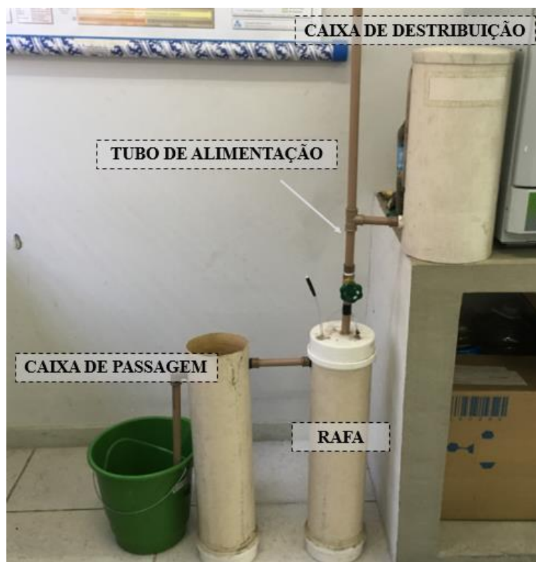
Figura 18. Planta de Tratamento de esgoto sanitário em escala laboratorial evidenciando o tubo de alimentação
